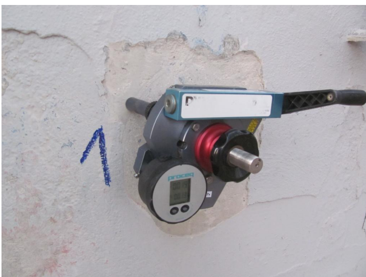
Foto 3 : Vlastní provedení odtrhové zkoušky – přístroj DYNA Z6.
