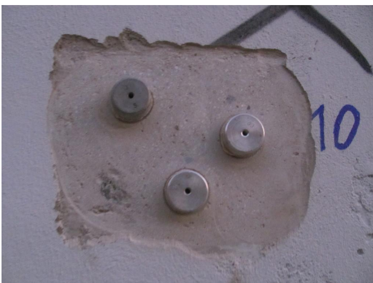
Foto 2 : Detail zkušebního místa s nalepenými terči.
